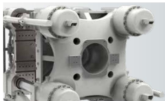
安装在定模板上的四个短程锁模油缸可快速建立锁模力，模具受力均匀，锁模力通过压力传感器可实时监控，锁模力重复再现性好
