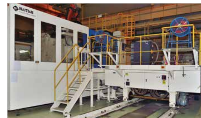
一键换模功能 便于模具自动化安装和拆卸。
