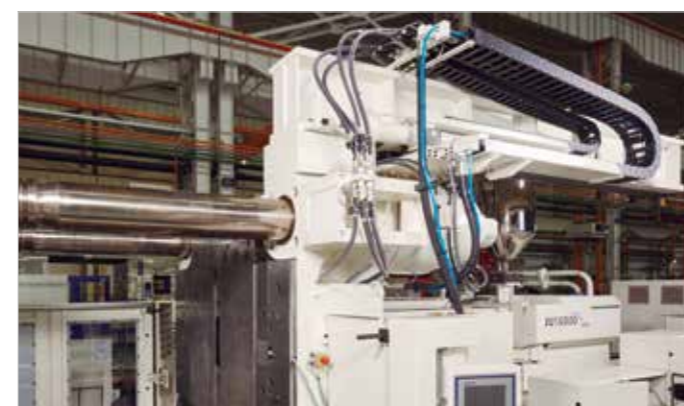
抽拉杆装置 便于模具安装和拆卸，适应各类模具安装，并且降低厂房高度要求。
