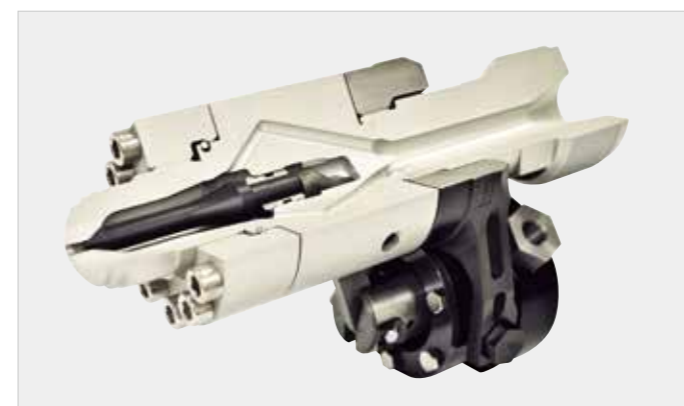
液压喷嘴 实现边开模边预塑，缩短产品成型周期。
