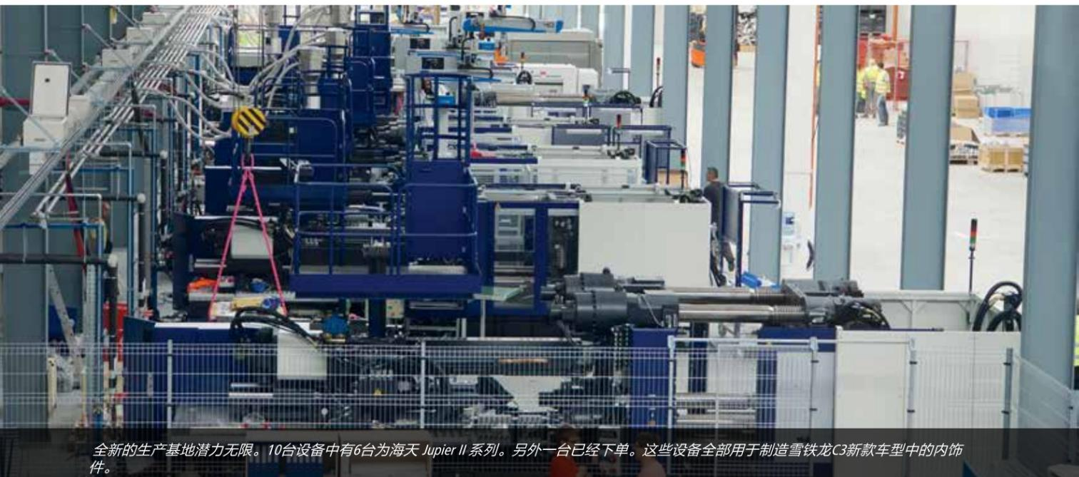
全新的生产基地潜力无限。10台设备中有6台为海天 Jupiter II 系列。另外一台已经下单。这些设备全部用于制造雪铁龙C3新款车型中的内饰件。
